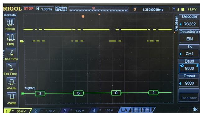
Figure 10: Der güene Kanal ist TX [ASC] in den Boxen steht das ASCII-Zeichen.
