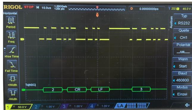
Figure 11: Das selbe mit 460800 baud und TRIGGER MENU.
