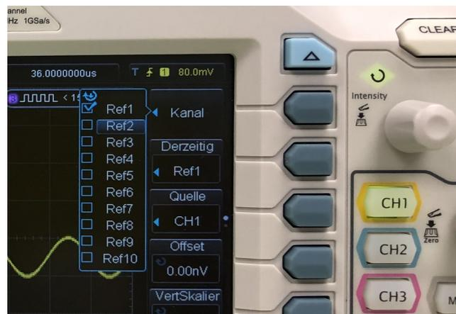
Figure 3: wir wählen einen der Referenzkanäle aus
