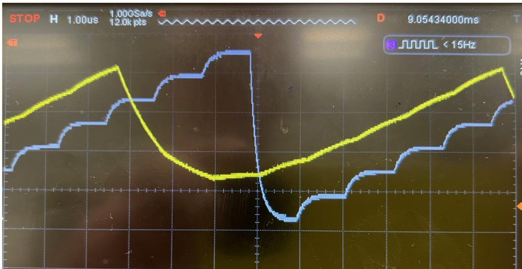
Abbildung 4: gelb - ohne Prüfspitze, hellblau - mit 10:1 Prüfspitze
