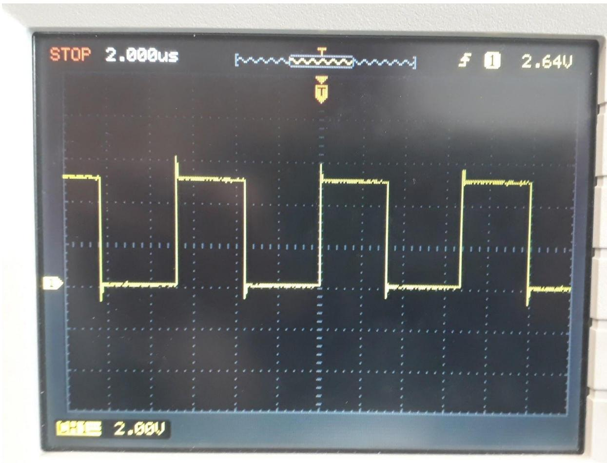
5V Amplitude 2,6μs HIGH und 2,8μs LOW.
