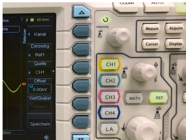
Figure 2: Nach dem Drücken der Taste "Ref" ändert sich das Menü am linken Bildrand
